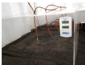
Câmara de tratamento com Ozônio
