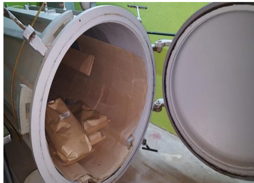
Sacos dentro da câmara teste de ozonização
